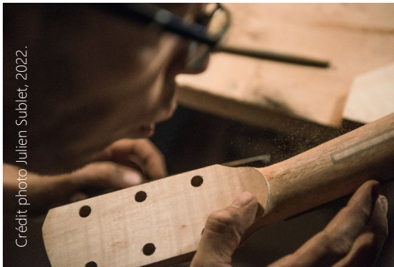
Figure 1 : Julien Sublet, luthier, travail au profilage d'un manche de guitare acoustique.
