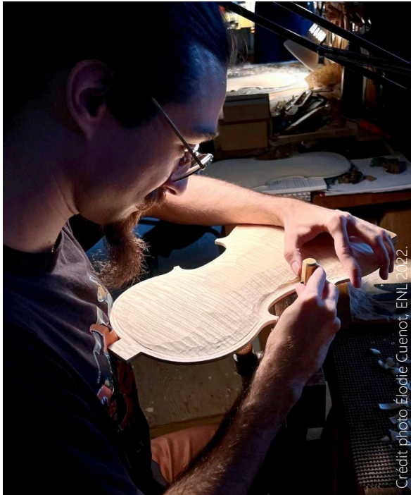
Figure 3 : Jacob Dupuis, finissant du Programme Techniques de métiers d'art option lutherie violon, trace à l'aide d'un trusquin l'emplacement des filets sur un dos de violon en érable.
